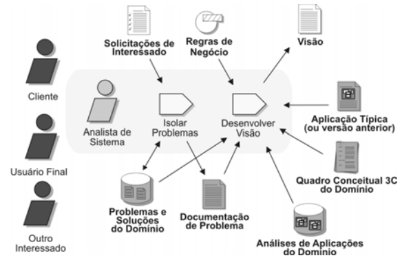
Figura 7. Principais atividades especificadas no detalhe de fluxo "Analisar Problema" da disciplina Requisitos do RUP-3C-Groupware
